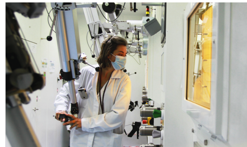
Les radiochimistes d'Arronax opèrent à l'aide d'un bras télémanipulateur
